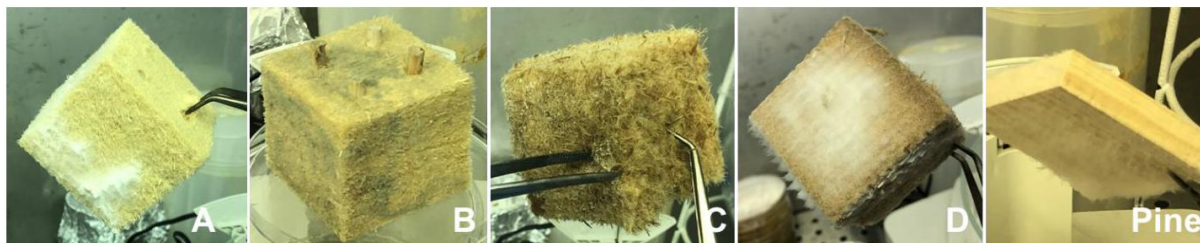
Figure 90. Observation visuelle après 48 semaines. La plus forte croissance fongique s'observe sur le test de bois massif. (Zirkelbach, Schöner, Tanaka, Sonntag, Ruisinger, Conrad, Stöcker, de Mets, et al. 2022, 28)
