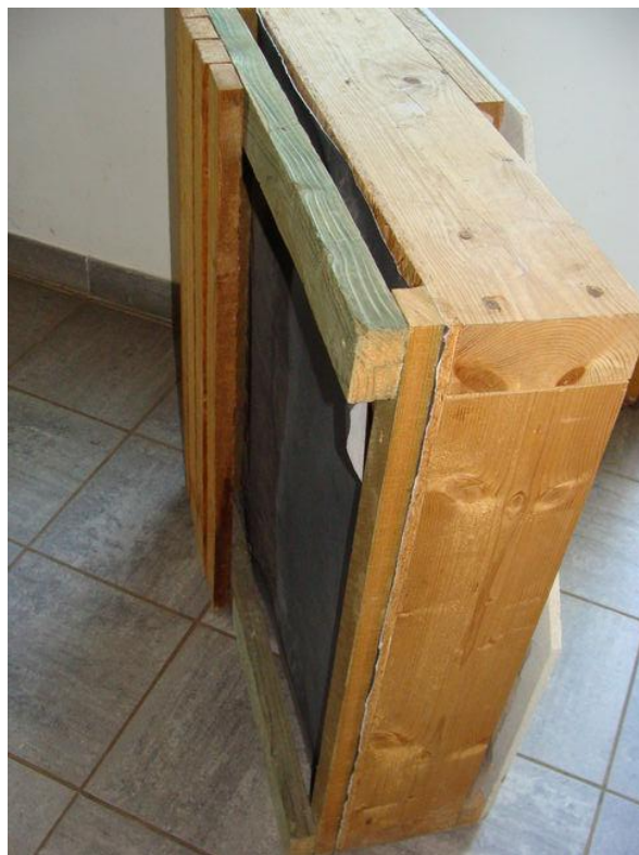
Figure 5. Reproduction du complexe d'isolation du bâtiment associatif qui sera analysé en cellule expérimentale
