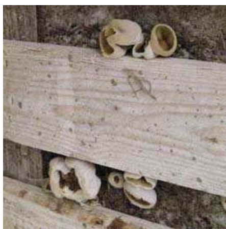
Figure 72. Corps fructifère et hyphes de champignons sur le béton végétal isolant.
