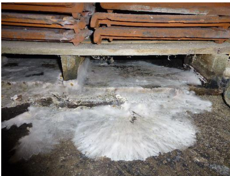
Figure 18. Mycélium colonisant une dalle en béton et démarrant initialement sur une palette en bois
